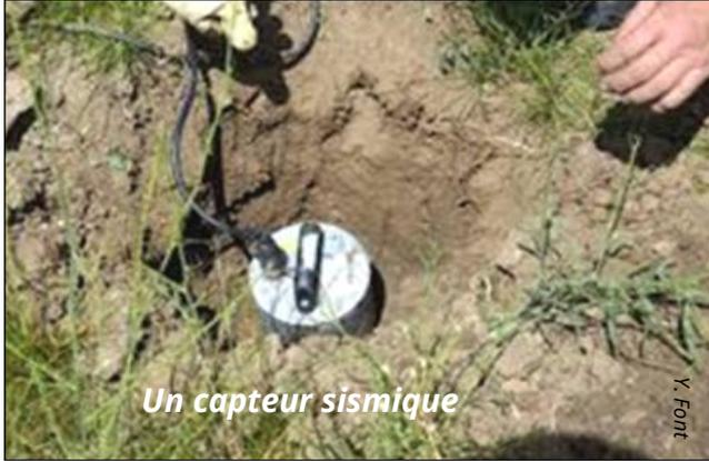
Un capteur sismique
